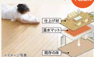
温水床暖房 フローリング仕上げ
